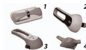
Рисунок 36: Фурнитура серии R (Rahrbach): 1 - дверная металлическая петля с регулировками в 3-х плоскостях; 2 - наружная поворотная ручка со встроенным замком; 3 - внутренняя поворотная ручка аварийного открывания; 4 - дополнительный затвор для дверей более 2400 мм по высоте.
