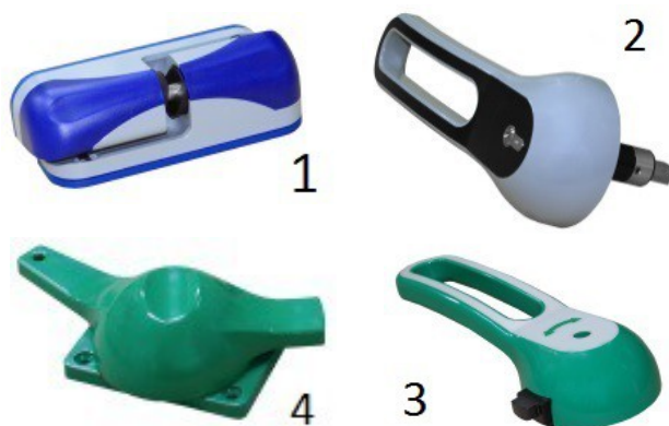
Рисунок 2: Фурнитура серии R (Rahrbach): 1 — дверная металлическая петля с регулировками в 3-х плоскостях; 2 — наружная поворотная ручка со встроенным замком; 3 — внутренняя поворотная ручка аварийного открывания; 4 — дополнительный затвор для дверей более 2400мм по высоте.
